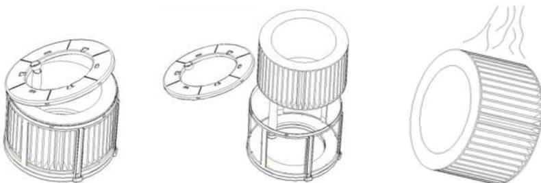
4.1 Retire la tapa situada en el extremo inferior del componente filtrante y separe el filtro de evaporación de su soporte.
